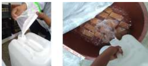
Figura 4. Exposición de ladrillos al ambiente agresivo simulado.
