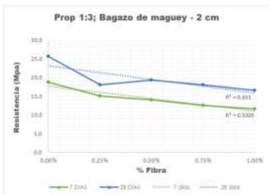
Figura 8. Resultados a 7 y 28 en cubos de mortero con proporción volumétrica 1:3 y diversos contenidos de bagazo de maguey con longitud de 2 cm.
