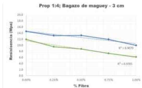
Figura 11. Resultados a 7 y 28 en cubos de mortero con proporción volumétrica 1:4 y diversos contenidos de bagazo de maguey con longitud de 3 cm.
