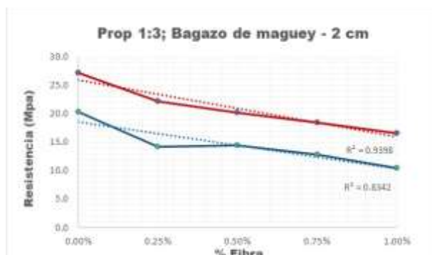
Figura 14. Resultados a 7 y 28 en probetas cilíndricas de mortero con proporción volumétrica 1:3 y diversos contenidos de bagazo de maguey con longitud de 2 cm.
