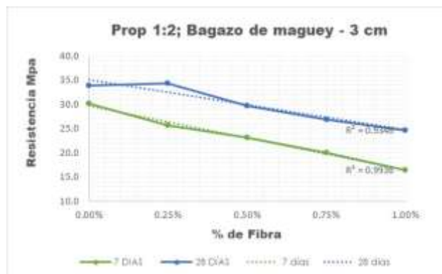
Figura 7. Resultados a 7 y 28 en cubos de mortero con proporción volumétrica 1:2 y diversos contenidos de bagazo de maguey con longitud de 3 cm.
