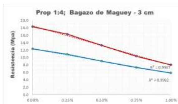
Figura 17. Resultados a 7 y 28 en probetas cilíndricas de mortero con proporción volumétrica 1:4 y diversos contenidos de bagazo de maguey con longitud de 3 cm.
