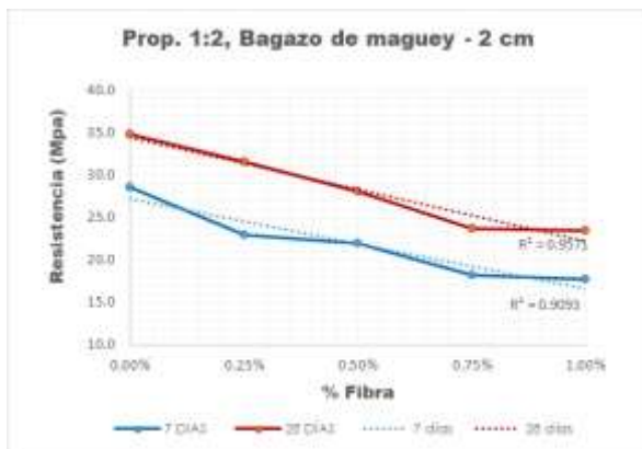
Figura 12. Resultados a 7 y 28 en probetas cilíndricas de mortero con proporción volumétrica 1:2 y diversos contenidos de bagazo de maguey con longitud de 2 cm.
