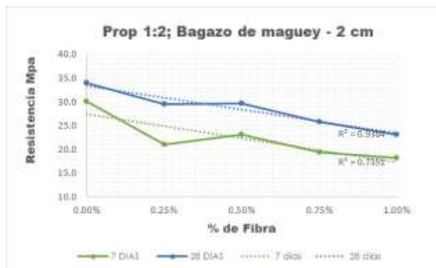
Figura 6. Resultados a 7 y 28 en cubos de mortero con proporción volumétrica 1:2 y diversos contenidos de bagazo de maguey con longitud de 2 cm.
