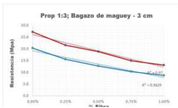
Figura 15. Resultados a 7 y 28 en probetas cilíndricas de mortero con proporción volumétrica 1:3 y diversos contenidos de bagazo de maguey con longitud de 3 cm.
