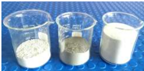
Figura 1. Materiales empleados para la elaboración de los morteros De izquierda a derecha a) Polvo de vidrio, b) Cemento y c) Arena sílica
