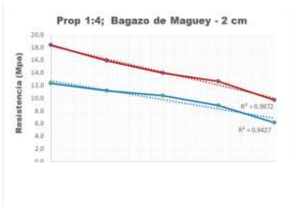
Figura 14. Resultados a 7 y 28 en probetas cilíndricas de mortero con proporción volumétrica 1:3 y diversos contenidos de bagazo de maguey con longitud de 2 cm.
