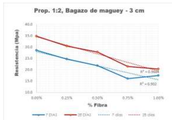
Figura 13. Resultados a 7 y 28 en probetas cilíndricas de mortero con proporción volumétrica 1:2 y diversos contenidos de bagazo de maguey con longitud de 3 cm.
