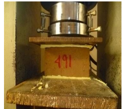
Fig. N°8.- Prueba a compresión axial del BTC.
