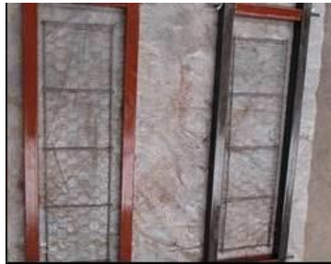
Figuras 2 y 3. Mallas empleadas durante la experimentación.
