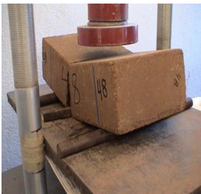
Fig. N°6.- Prueba a la flexión del BTC
