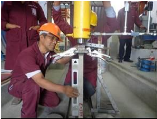
Figuras 16 y 17. Detalles de la colocación en el marco de carga e instrumentación de las placas de mortero armado.
