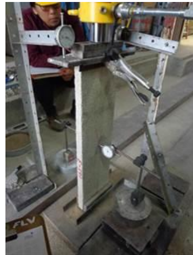
Figuras 16 y 17. Detalles de la colocación en el marco de carga e instrumentación de las placas de mortero armado.
