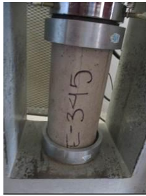
Figuras 18 y 19. Aspectos del ensayo de cilindros para determinar su resistencia a la compresión axial y módulos de elasticidad.
