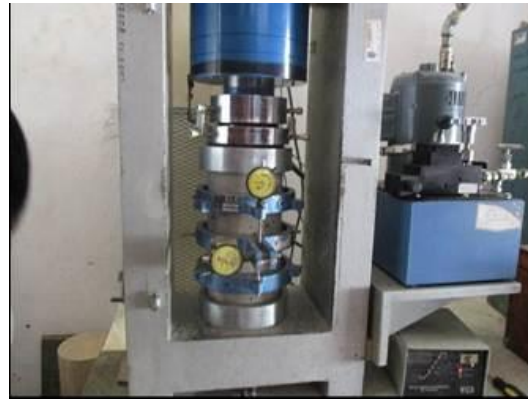
Figuras 18 y 19. Aspectos del ensayo de cilindros para determinar su resistencia a la compresión axial y módulos de elasticidad.
