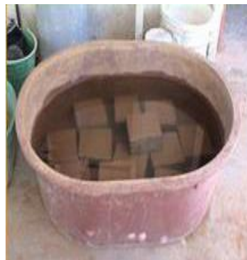
Fig. N°7.- Prueba a la inmersión en agua el BTC por término de 24 hr.
