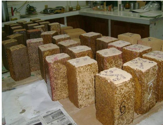
Figura 3. Recubrimiento de cuatro caras de las probetas con barniz epóxico transparente.
