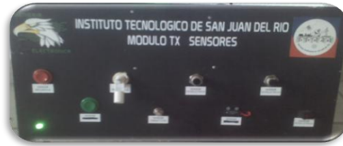
Figura 12. Módulo con Sensores Inalámbricos mediante protocolo ZigBee .
