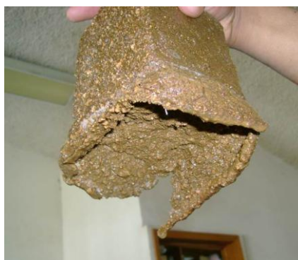
Figuras 6 y 7. Deterioro de probeta elaborada con mucílago de nopal.
