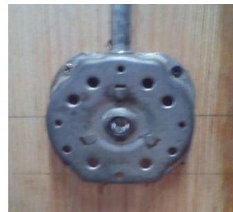
Figura. 6. Soporte de la armadura.
