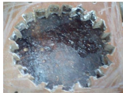
Figura. 3. Corte de las ranuras de la parte estática.
