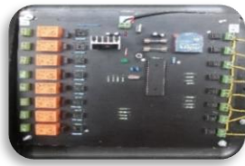
Figura 10. Modulo de Recepción de datos con XBee, decodificador y salida a relevador.
