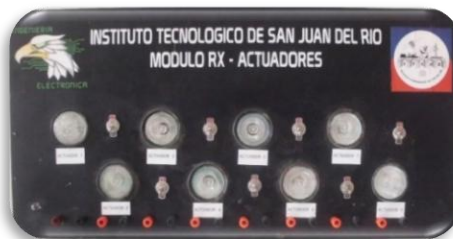
Figura 13. Módulo con Actuadores Inalámbricos mediante protocolo ZigBee
