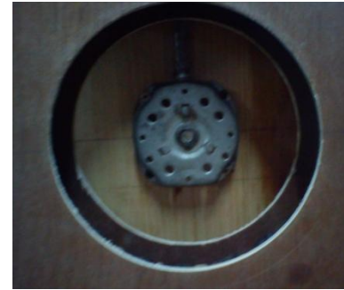
Figura. 7. Alineación de la base fija y la giratoria.
