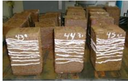
Figuras 10 y 11. Detalles de la velocidad de penetración de humedad en BTC elaborados con suelo, cemento y mucílago de nopal.
