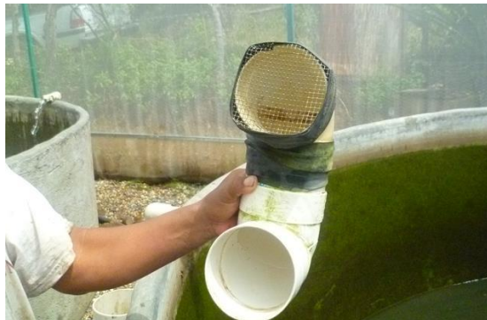
Figura 18. Sistema de filtro tipo "U", sumergido 5 cm con una malla en un extremo para evitar que los alevines y alimento flotante sea arrastrado directamente durante el llenado y el desalojo del agua en exceso es únicamente al alcanzar su nivel.
