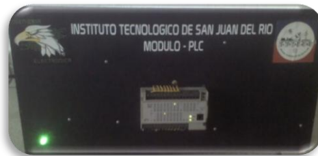
Figura 11. Controlador Lógico Programable Inalámbrico mediante protocolo ZigBee.
