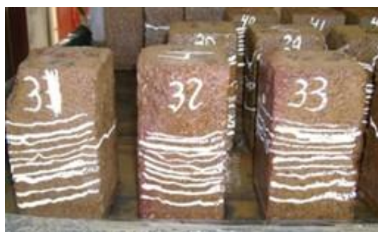
Figuras 8 y 9. Detalles de la velocidad de penetración de humedad en BTC elaborados con suelo, cemento y agua
