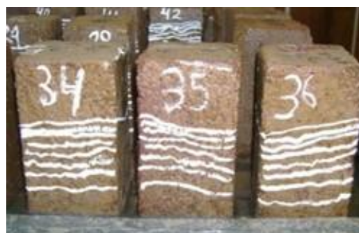
Figuras 8 y 9. Detalles de la velocidad de penetración de humedad en BTC elaborados con suelo, cemento y agua
