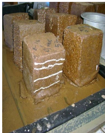
Figuras 6 y 7. Deterioro de probeta elaborada con mucílago de nopal.
