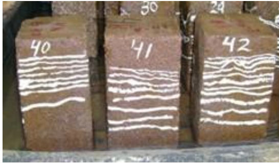
Figuras 10 y 11. Detalles de la velocidad de penetración de humedad en BTC elaborados con suelo, cemento y mucílago de nopal.
