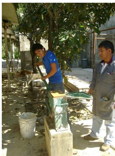
Figura 2. Compactación de BTC en una máquina compactadora manual.
